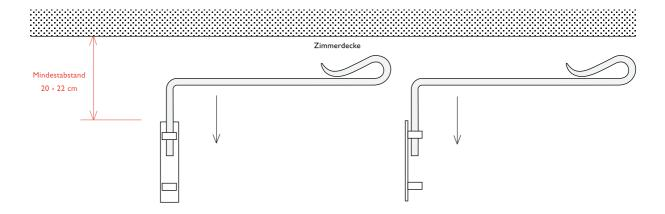
Die Schwenkstange SPRING wird standardmäßig von oben in den Träger eingehängt (siehe Darstellung). Achten Sie deshalb auf einen **Mindestabstand von 20 cm bis 22 cm bis zur Decke**.
