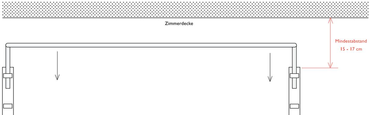
Das Modell EPONA line wird standardmäßig von oben in die Träger eingehängt (siehe Darstellung). Achten Sie deshalb auf einen **Mindestabstand von 15 bis 17 cm bis zur Decke**.
